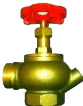
Es utilizada para unirse en redes contra incendio, que requieren verificar la presión en la red ya que cuenta con salida para colocar manómetro, cuenta con vástago ascendente para la apertura al paso del agua y cierre total. Disponibles con cuerdas IPT, NST, NPT, ", con entrada hembra y salida hembra o macho.
