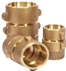
Coples para instalarse en la manguera de servicio de agua contra incendio ya sea de una capa o doble capa. El cople se divide en dos partes (conexión macho y conexión hembra) para instalarse mediante expansión interna en los extremos de la manguera. El diseño interno permite una mejor sujeción interna a la manguera y un fácil rosado a través de las orejas de apriete integradas.
