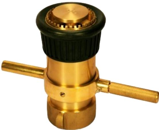
Boquilla para monitor Fabricadas en bronce amarillo y , con entrada Hembra giratoria de 2  $\frac{1}{2}$ " NST con gasto de agua de 250, 350, 500, 750 y 1000 GPM
