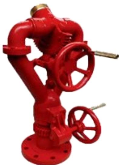
Cuenta con mecanismo de giro horizontal de 360° accionado por volante con manivela y giro vertical de 120° por medio de volante con manivela. Su base bridada de 4" (150 LBS) de cara realizada con salida de 2 1/2" macho para conectarse a boquillas reguladoras de chorro de agua.
