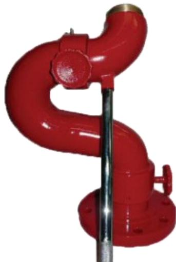
Cuenta con mecanismo de giro horizontal de 360° accionado por volante con manivela y giro vertical de 120° por medio de volante con manivela. Su base bridada de 4" (150 LBS) de cara realizada con salida de 2 1/2" macho para conectarse a boquillas reguladoras de chorro de agua.
