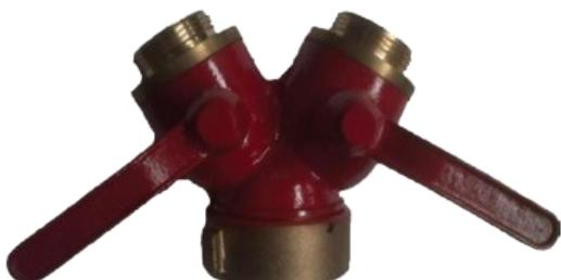
Son dispositivos utilizados para confluir varios flujos de líquido en uno solo. Conexión siamesa para uso en línea de manguera, con válvula de apertura y cierre rápido que operan de manera independiente. Fabricadas en fundición de bronce, las salidas cuentan con un empaque sólido que sella herméticamente el paso del agua.
