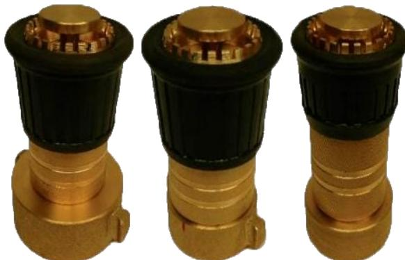
chiflones o boquilla para manguera contra incendio fabricados en bronce, manejan tres patrones de agua (chorro directo media neblina y neblina) controla el cierre total del paso de agua, fabricado en diferentes medidas  $1\frac{1}{2}''$ ,  $2''$ ,  $2\frac{1}{2}''$  y en sus diferentes cuerdas ipt o nst
