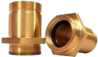
Diseñado para unirse en rack o soportes de despliegue rápido para conectar manguera contra incendio a la válvula de globo. Cuenta con un hexágono para apretarlo fácilmente. Fabricados con extremos MACHO-MACHO y HEMBRA-MACHO en cuerdas IPT y NST.
