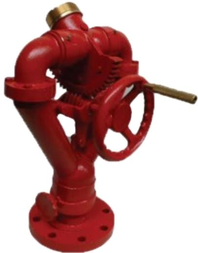
Cuenta con mecanismo de giro horizontal de 360° por medio de un volante con manivela. Su base bridada de 4" (150 LBS) de cara realizada con salida de 2 1/2" mano para conectarse a boquillas reguladoras de chorro de agua.
